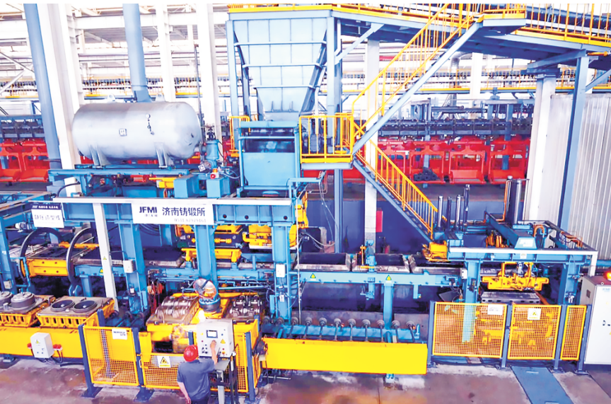
裕川机械引进的国际先进HWS静压造型线。
