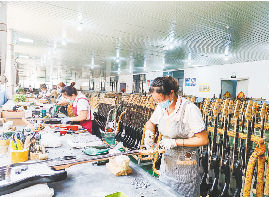
△昌乐昌韵达乐器有限公司的现代化生产车间内，工人正在制作电吉他。
