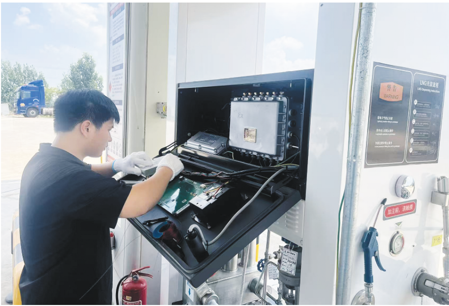
检定人员冒高温开展加气机强制检定工作。
